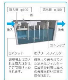
設置例/1槽式シンク+沈殿槽
